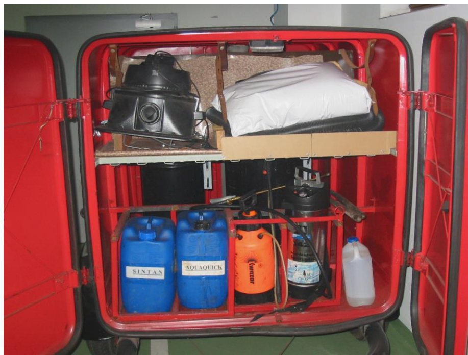
P –EKOL Przyczepka ekologiczna - wyposażona w sprzęt i środki do usuwania zdarzeń, w których wystąpiły materiały niebezpieczne.
