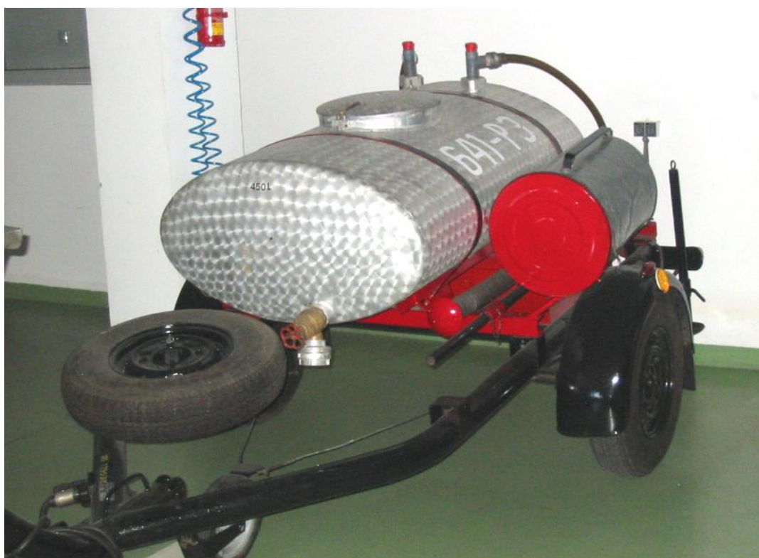
Przyczepka na środek pianotwórczy – zawierająca 250 l. Deteoru.
